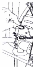
Retirar la junta tórica usada y colocar la nueva junta tórica
