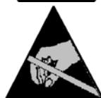
**Atención:** La inobservancia de esta indicación puede provocar daños en el aparato por descarga electrostática. Los componentes electrónicos del mando del humidificador son muy sensibles a las descargas electrostáticas. A fin de proteger estos componentes, se deberán tomar medidas de prevención de daños por descarga electrostática (protección ESD) para todos los trabajos de instalación.
