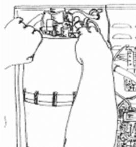
Colocar el cilindro de vapor en vertical en el pie de apoyo
