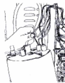
Volver a conectar el cable de conexión para los elementos calefactores
