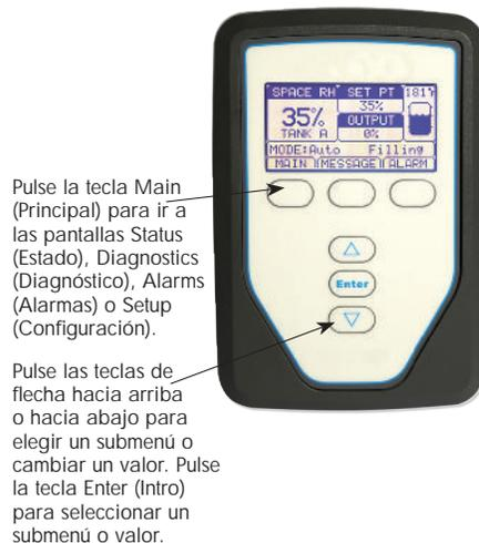
Pulse la tecla Main (Principal) para ir a las pantallas Status (Estado), Diagnostics (Diagnóstico), Alarms (Alarmas) o Setup (Configuración).
