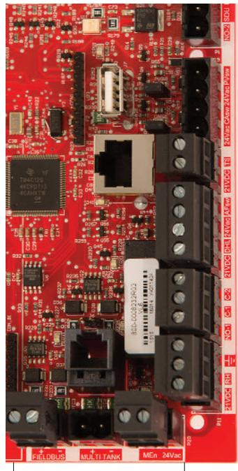
Terminales de conexión de campo. Los terminales P-11 a P-16 tienen un borde blanco en la placa de control. Aquí es donde realizará la mayoría de las conexiones de cableado de campo.
