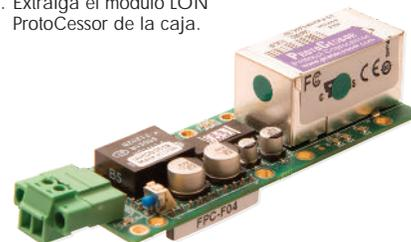
2. Inserte el módulo LON ProtoCessor en las patillas de la placa de control.
