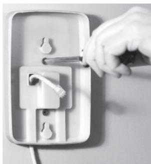
Monte el teclado/pantalla en la caja de conexiones.
